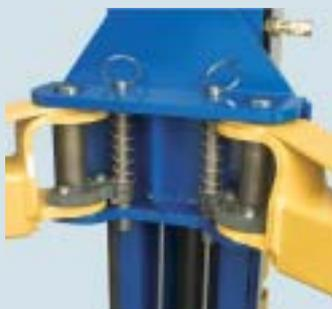
I bracci portanti vengono arrestati automaticamente durante il sollevamento. Se il ponte è completamente abbassato, il dispositivo di arresto viene sbloccato autonomamente. Per un maggior confort d'uso, la segmentatura d'arresto è fine e dispone di una funzione di sgancio manuale.
