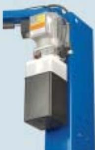
Il potente gruppo idraulico è flangiato in tutti i modelli E ed i nella zona superiore della colonna. Come protezione da sovraccarico il motore è dotato di un interruttore termico. Protetto da agenti esterni, esso offre una maggiore libertà di movimento e una minore rumorosità al posto di lavoro.
